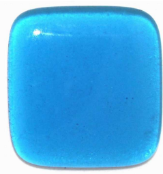
3 vrstvy, celkem 9mm Sklo se rozleje a nafoukne
