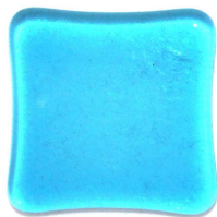
1 vrstva, celkem 3mm Sklo se smrštilo
